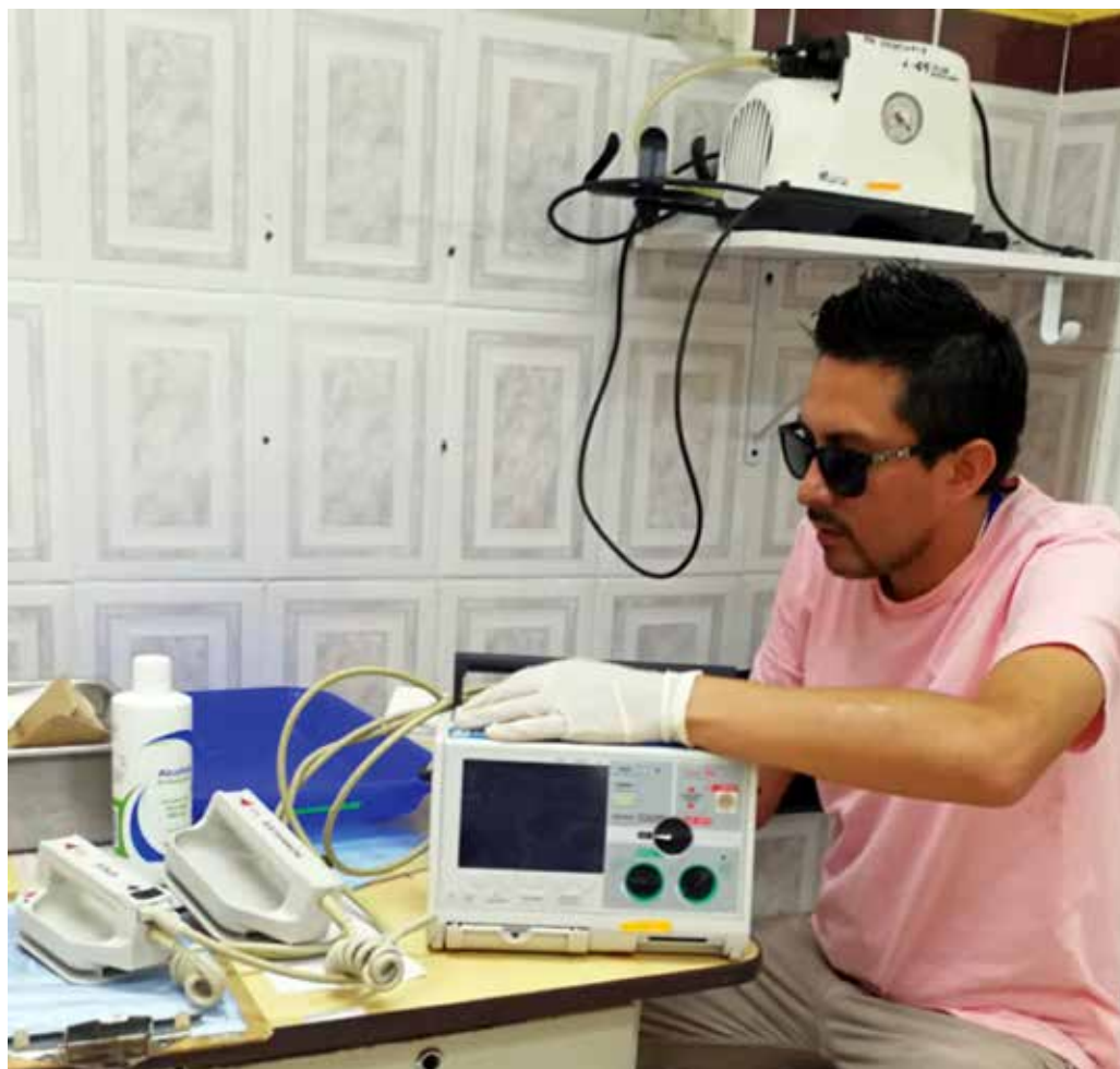
Figura 2.9 Mantenimiento preventivo del desfibrilador
