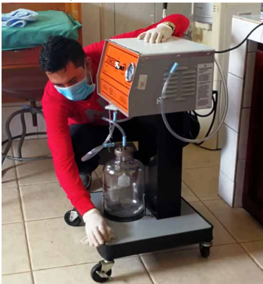
Figura 2.15 Mantenimiento del succionador
