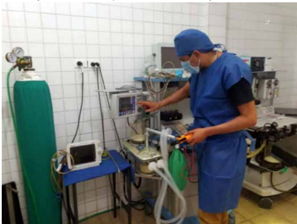
Figura 1.8 Calibración y mantenimiento de la máquina de anestesia
