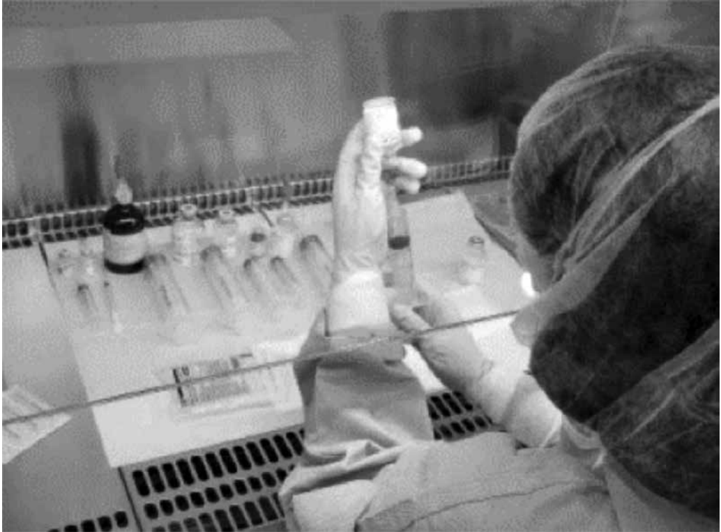
Figura 26. Técnico con la vestimenta adecuada para trabajar en zonas limpias bajo campana de flujo laminar
