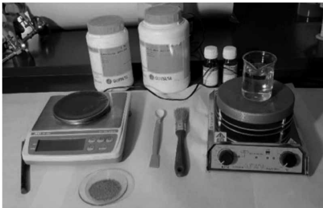
Figura 22. Balanza (izquierda) y agitador (derecha) en la zona de elaboración de un laboratorio galénico
